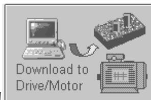
按下 **Download to Drive/Motor** 按钮以下载您的设置数据到驱动器/电机的 **EEPROM** 存储器中，以设置表形式存储。从现在开始，每次上电时该设置数据将被复制到驱动器/电机的 **RAM** 存储器中供运行期间使用，也可用 **Save** 将设置数据保存在您的电脑上并用于其他应用
