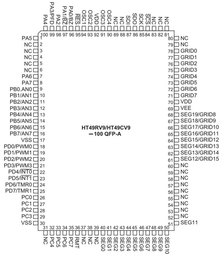
注： 每个 V<sub>DD</sub>(V<sub>SS</sub>)引脚都必须连接到系统的 power(ground)
