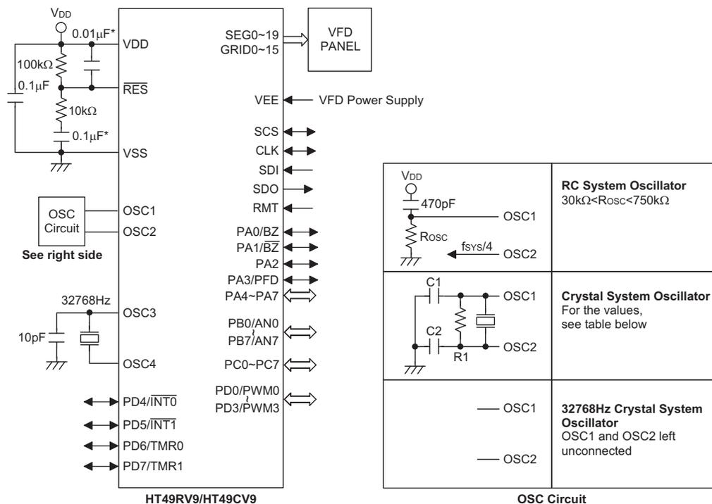
注： 复位电路的电阻和电容值选取的原则是使 VDD 保持稳定并在  $\overline{\text{RES}}$  置为高以前把工作电压保持在允许的范围。
