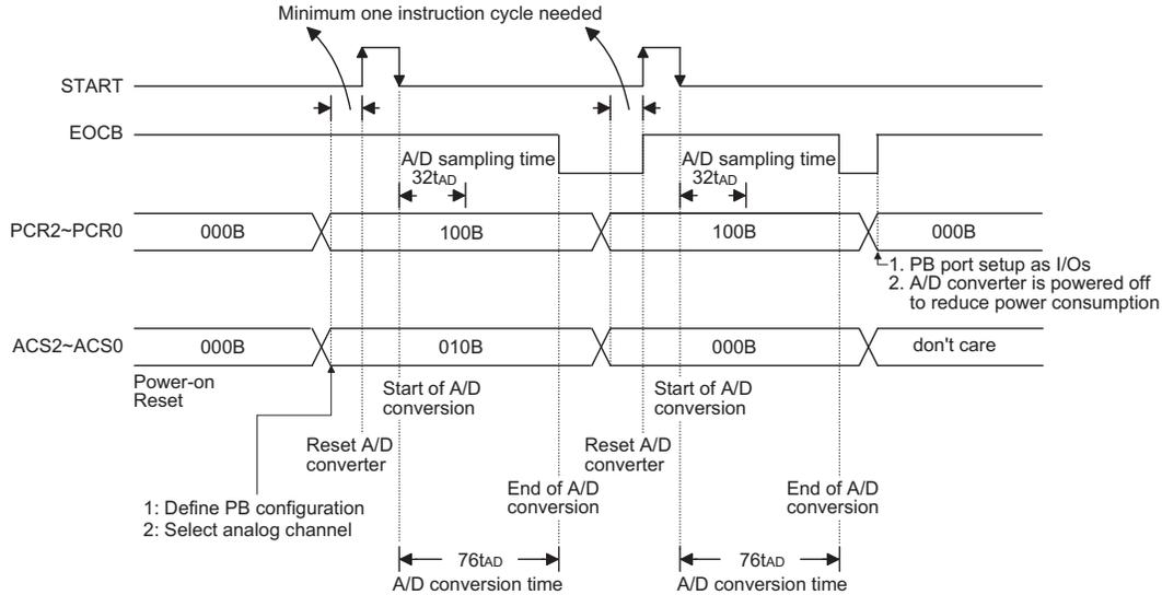
Note: A/D clock must be  $f_{sys}/2$ ,  $f_{sys}/8$  or  $f_{sys}/32$
