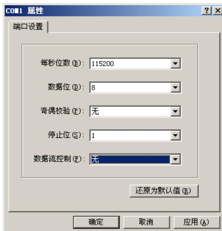
当所有的连接参数都设置好以后，打开NewMsg-2440电源开关，系统会出现启动界面。选择超级终端“文件”菜单下的“另存为…”，保存该连接设置，以便于以后再连接时就不必重新执行以上设置了。
