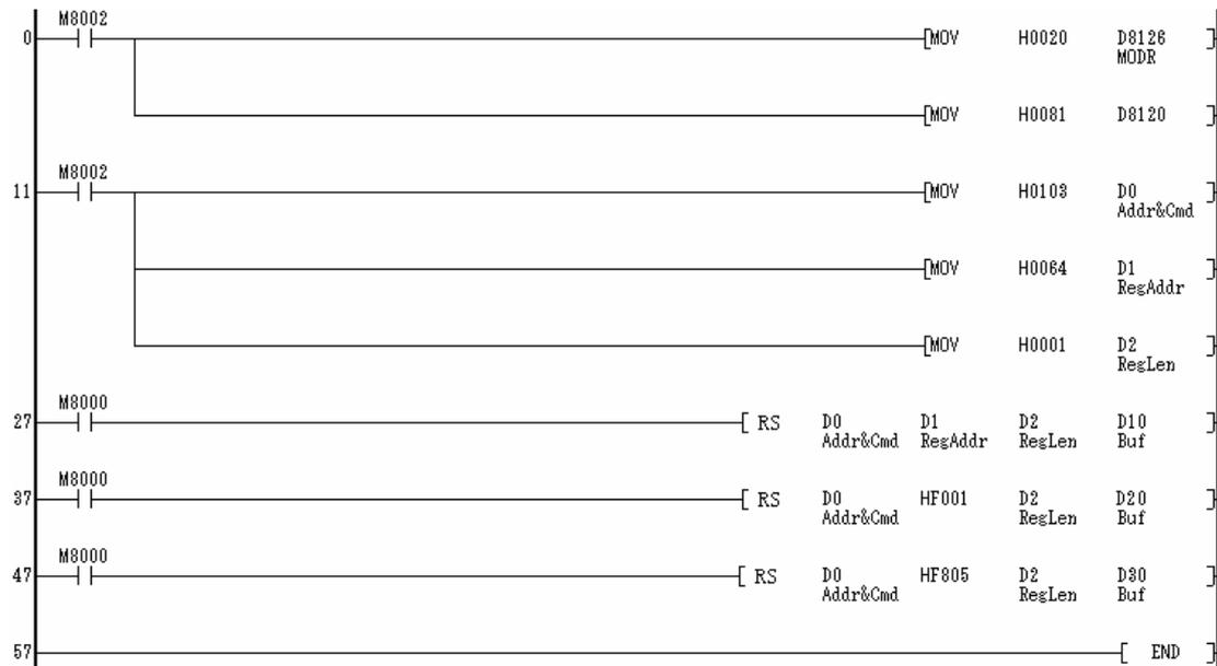
执行结果，PLC 通过串口 COM1 依次循环发送以下三帧数据（16 进制）：
