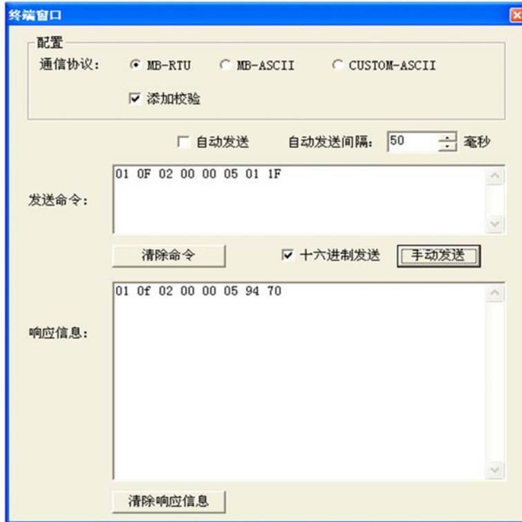
图 3.11 MB-RTU 模式下发送命令帧
