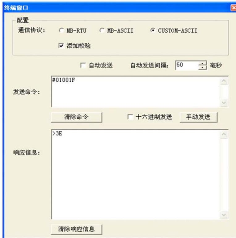
图 3.12 Custom-ASCII 模式下命令帧的 ASCII 字符发送
