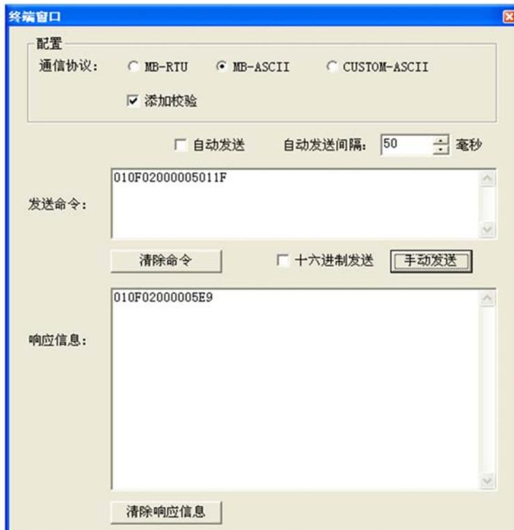
图 3.12 MB-ASCII 模式下命令帧的 ASCII 字符发送
