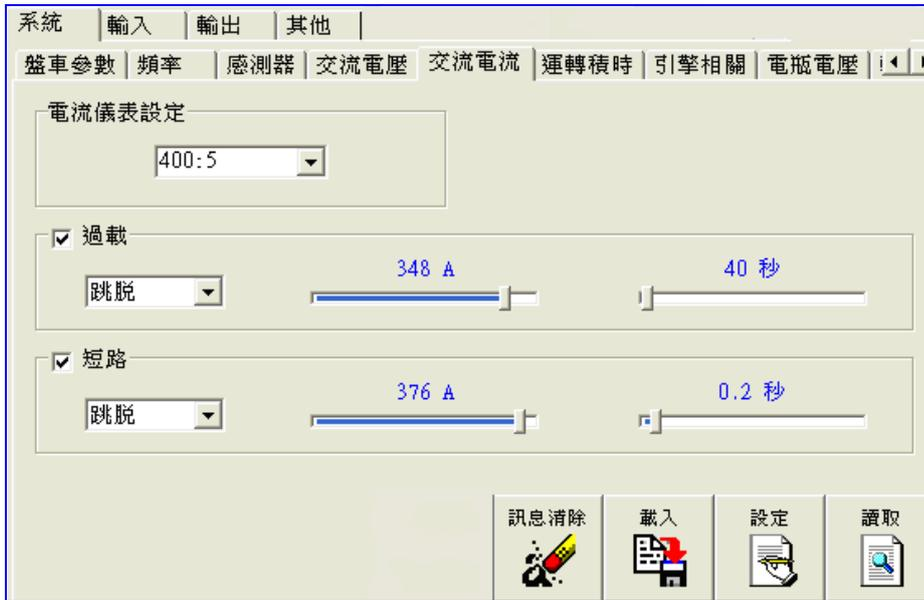
图 26 电流参数设定
