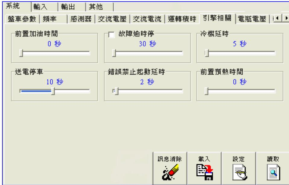
图 28 引擎相关参数设定
