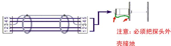
将探头的接地端与管道或支架的接地端连接, 用四芯加屏蔽电缆将探头与控制盒的 5 针端子 (表板图中 2 号) 相连, 要保证同一条颜色的电线连接编号一致的端子, 如用 Braden 9534 线连接, 各端子号的定义如下:
