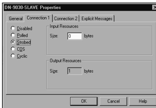
90-30 系列 DeviceNet 从站模块的选通 I/O Messaging 配置界面
