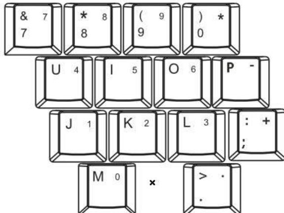
数字键方便您输入数字或做计算用。按下 **Fn+NumLk** 键后，屏幕右下角显示 图标，表示数字键已锁定，您便可使用数字键。
