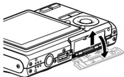
2. Posizionando la scheda di memoria in modo che il suo davanti sia rivolto nella stessa direzione dello schermo monitor della fotocamera, inserire con attenzione la scheda nell'apposita fessura. Inserire la scheda fino in fondo finché la si sente scattare saldamente in posizione.
