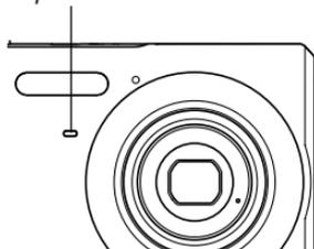
\* Le spie lampeggiano in tre modi. Il modo 1 consiste nel lampeggiamento una volta al secondo, il modo 2 consiste nel lampeggiamento due volte al secondo e il modo 3 consiste nel lampeggiamento quattro volte al secondo. La tabella riportata di seguito spiega cosa significa ciascun modo di lampeggiamento.
