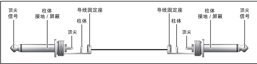
图 10.1：带 6.3mm 单声道插头的不平衡式的直柄插头接线
