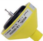
本器は、放電ガンに取り付けて静電気放電の電流波形の立ち上がり時間を、IEC61000-4-2 規格の0.7~1.0nsより0.2ns近くに高速化するものです。
