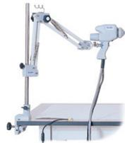
本製品は、IEC61000-4-2をはじめとする静電気試験環境の改善を目的に従来の自立型スタンドを改良し、放電ガンの据付・脱着を容易に、しかも放電ガンを供試体の試験位置へ任意に移動・設定できるように開発したものです。本製品を使用することにより放電ガンを上下・左右の任意の位置に移動して試験がおこなえます。(IEC規格対象外品)
