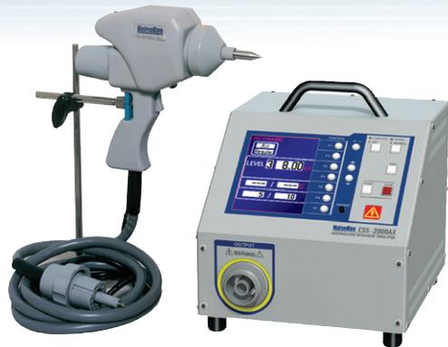
人体や物体などに帯電したエネルギーが、電子機器へ放電した際の耐性を評価するEMC試験器です。
