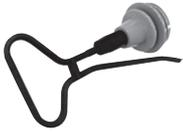
衝撃磁界アダプタは、ノイズの誘導モードである、電磁誘導をシミュレーションするためのアダプタであり、静電気試験器と放電ガンとを組み合わせ使用します。
