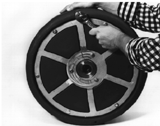
图23 — 拆下尾杆固定螺栓
