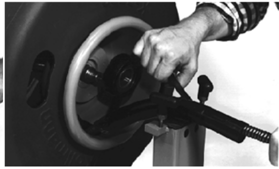
图22 — 拆下导向软管
