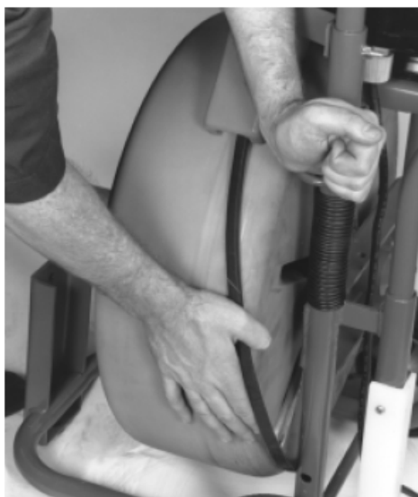
图8 — 松开皮带张紧装置
