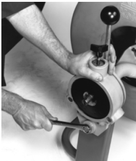
图7a — 用3/4" 拆下螺栓和自动进索机构
