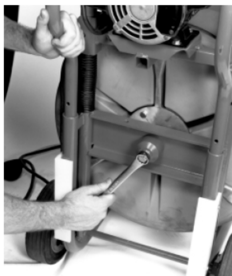
图9 — 拆下钢索鼓固定螺栓
