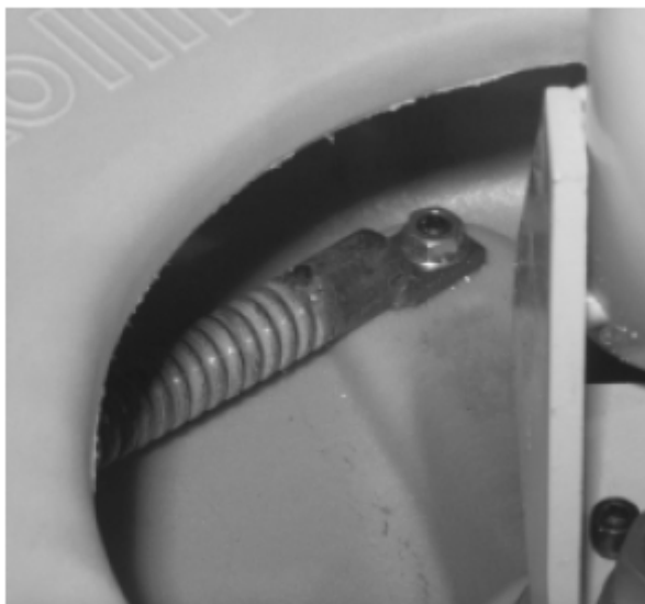
图11 — 拆下尾杆固定螺栓
