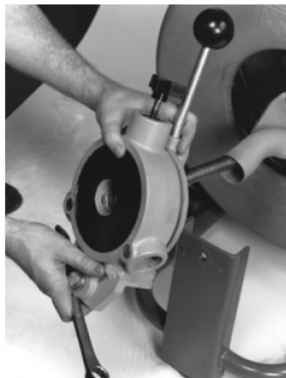
图7b — 用3/4" 拆下螺栓和自动进索机构
