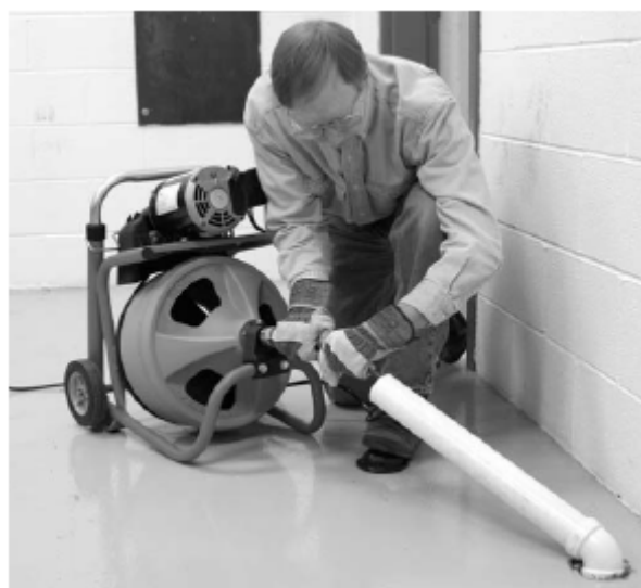
图9 — 使用延长管来保护钢索
