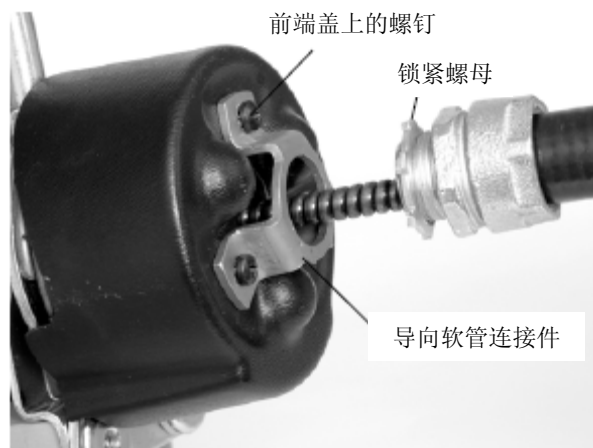
图5 — 安装导向软管至自动进索机构
