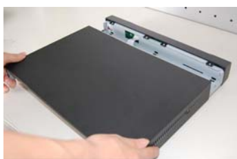
②拆卸机壳。
