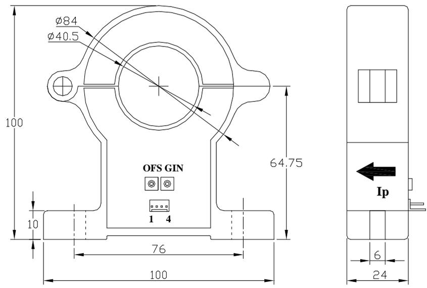
引脚输出：1,+15V 2,-15V 3,Vout 4,0V(电源地) OFS,零点调节 GIN,幅度调节
