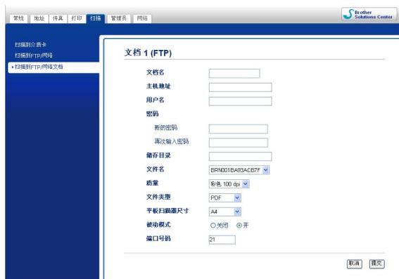
可根据 FTP 服务器和网络防火墙配置将**被动模式**设置为**关闭**或**开**。默认设置为**关闭**。也可更改用于访问 FTP 服务器的端口号。默认设置为端口 21。在大多数情况下，可以保留上述两项设置的默认设置。
