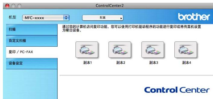
要使用**副本**按钮，点击按钮同时按住 **Ctrl** 键配置打印机驱动程序。
