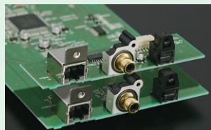
トランスポート出力端子とデジタル入力端子 Assy
