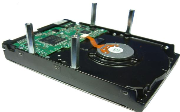
3. 觀察主板內部結構, 整理好 SATA Cable 與電源線, 並查看四根鐵柱欲固定的位置(如圖中四個藍色圈圈), 以防碰撞到主板上其他元件.
