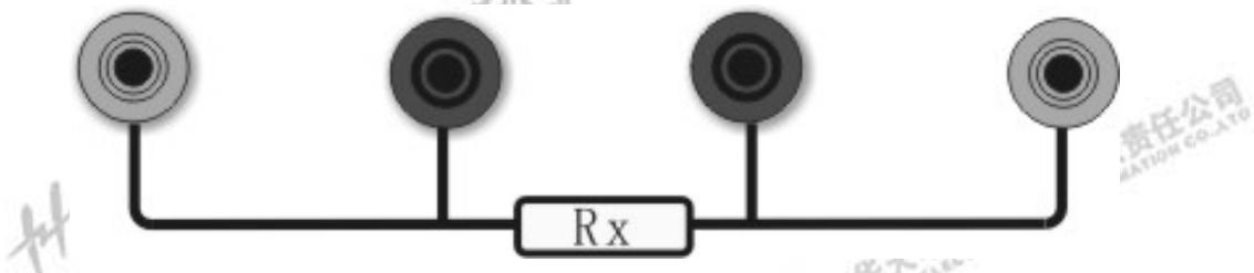
输入输出接线端子如上图所示，共 4 只接线柱，其中外侧两只红色接线柱为电流输出，内侧两只接线柱为测量电压采样输入。
