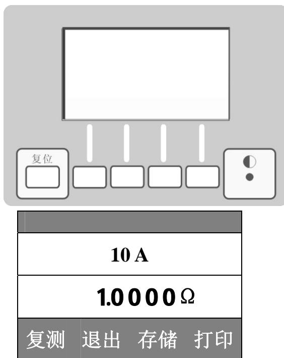
上图为液晶显示器和键盘组件组成的显示控制部分，其中显示器为点阵式液晶显示屏，用于显示操作提示、测量结果、以及指示显示屏下部 4 个多功能按键的用途。左侧的“复位”键可使仪器在出现死机或从菜单退出时直接返回到初始状态。最右侧的小孔为显示器对比度调节孔，在显示器出现显示图形对比度过深或过浅，影响阅读效果时，可以用小型“一”字改锥进行适当调节。
