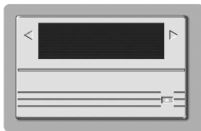
本仪器提供的是 16 行微型面板式打印机，使用寿命长、打印速度快、更换打印纸和色带容易，无须其他维护和保养。整机电源接通后打印机右下角指示灯亮，表示打印机处于待机状态，测试中或测试完毕后根据显示提示按下打印键就可打
