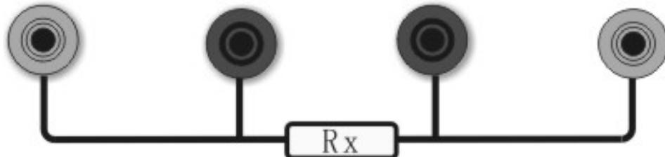
输入输出接线端子如上图所示，共 4 只接线柱，其中外侧两只红色接线柱为电流输出，内侧两只接线柱为测量电压采样输入。
