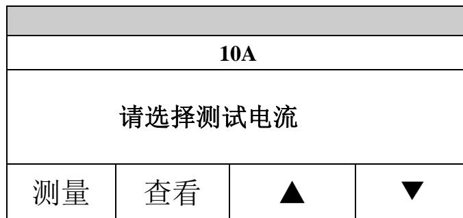
直阻仪提供了几种不同的测量电流，您可以根据需要按“▲”和“▼”键进行选择，请注意每种测量电流的最大测量范围，以免出现所测绕组直流电阻大于所选电流的最大测量范围，使测量开始后电流达不到预定值，导致直阻仪长时间处于等待状态（详细的技术参数请参见技术指标一节）。
