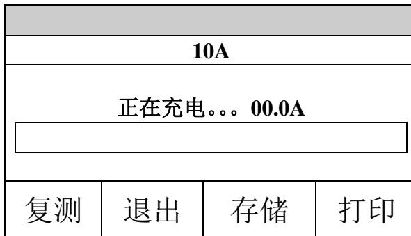
显示器中部显示区将出现一个充电进度条，进度条上部为当前的电流值，一般在测量大电感负载时，电流达到稳定需要一定时间，电流值由零向额定值上升。
