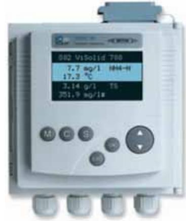
DIQ/S182 是传统的单参数仪表的最佳替代方案，它可同时接两支 IQ 数字传感器，典型应用在于监测污水厂的硝化/反硝化反应过程、进水口或出水口，企业污染源的排放口，水质自动站水质断面监测，工业过程监测与控制等领域。扩展功能时 182 系统只能接专用的 DIQ/JB 接线模块和 DIQ/CHV 电磁阀清洗模块。当使用大功率数字传感器，如 NitraVis, CarboVis, NiCaVis 700 IQ 光学传感器时，可再选配一个 MiQ/PS 电源模块。182 系统允许最大的接线距离为 250 米。它标准配有 3 组继电器输出，信号输出有 2 种：2 组模块电流输出或总线输出（Profibus 或 Modbus）。
