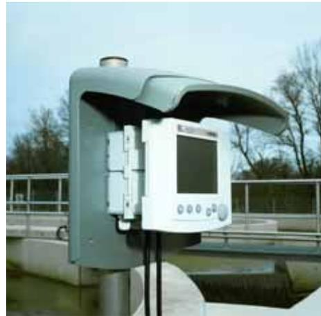
MIQ/S184 XT 是 IQ Sensor Net 系列仪器的最基本型号，包括 3 个部件模块：MIQ/C184 XT 显示/控制器，MIQ/CR3 输出模块，MIQ/PS 电源模块。这三个模块出厂时就预先叠加在一起，有两种版本，输入电压分别为 90-264VAC 和 24VAC/VDC。可立即用 MIQ/S184 XT 直接替换现有的单参数在线监测仪。如果要测试其它参数，或扩展测试点，很简单，只需再加一支相应的传感器就可以了，总共可同时接 12 支传感器。如果输出信号（3 组电流，3 组继电器）不够用，可再选配 2 个输出模块。如果测试点之间距离过长，则可随时加一个接线模块 MIQ/JB。显示终端 T2020 也可并入到 184 XT 系统中，主要用来在测试点附近校正。184 XT 系统配置灵活多样，是在线多参数监测首选的经济有效的解决方案。
