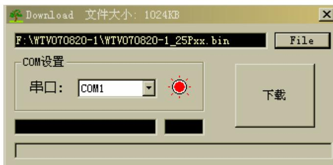
下载成功后，将WTVxxx-SxxV1模块插入232烧写器插座，依次按擦除→烧写→校验步骤操作，工作过程中，红色LED指示灯闪烁，绿灯亮后，指示该步骤
