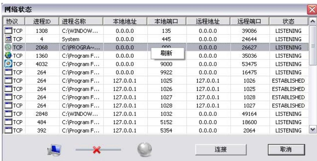
通过网络状态对话框可以了解本地机所有已经启动进程的网络连接情况,还可以控制本地机与 Internet 的连接和断开。
