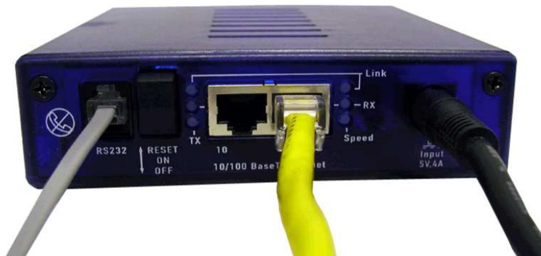
注意：RS-232 在 ICE 后面板上，不要将 RS232 端口和 ICE 前面板上的 TGTCONS 混淆。
