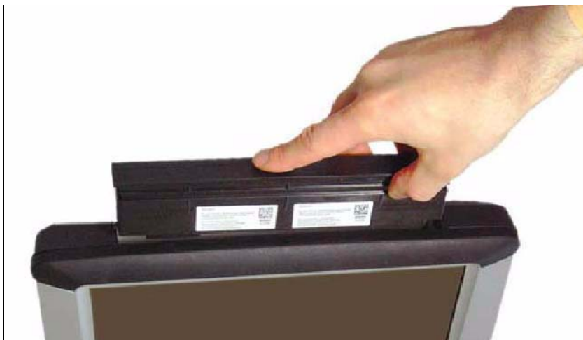
图 4-1 将蓄电池包装入测试仪
