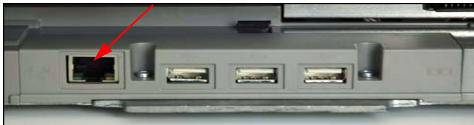
图 6-3 基座的接口模块，箭头所示为 RJ45 接口，右侧为 3 个 USB 接口
