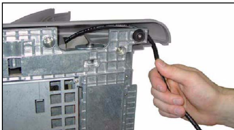
图 6-1 电源导线的布线
