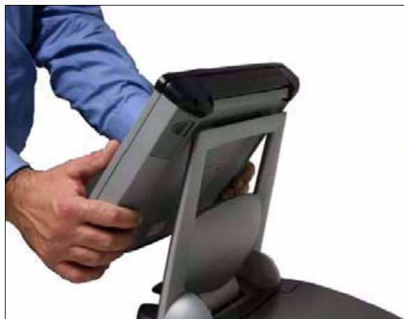
图 6-4 将测试仪装入基座中
