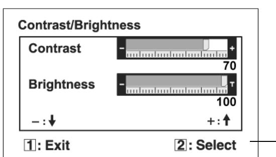
控制屏幕底部的命令行显示在此屏幕之后下一步要做什么。可在控制屏幕之间切换、调节选择的选项或者退出屏幕。
