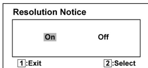
如果启用上面所示的 "分辨率提示", 且计算器设置为 1680 x 1050 之外的分辨率, 将显示以下屏幕。
