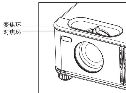
1. 旋转聚焦环，使图像聚焦。建议聚焦时用静止图像。
