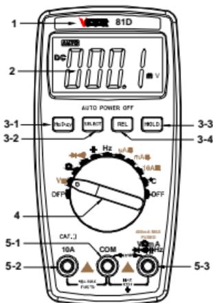
4. 旋钮开关：用于改变测量功能及量程。
