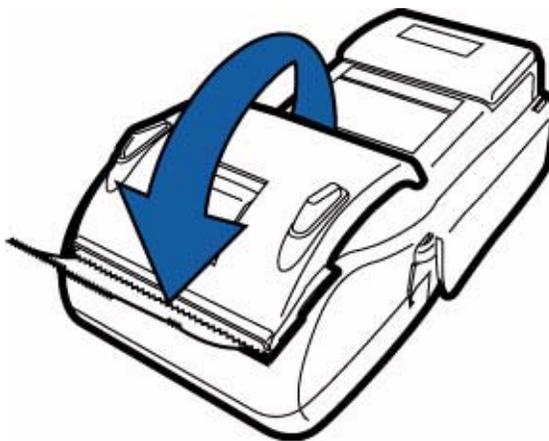
图 15 关闭打印机盖
