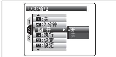
开启此功能可节约电源以获得最长电池使用时间。相机10秒不使用时，LCD显示屏自动变暗。
