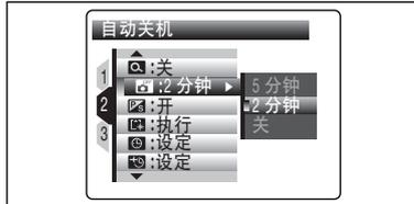
此项功能开启时，如果相机继续闲置2分钟或5分钟，将自动关机。自动关机功能可防止长时间开启电源。
