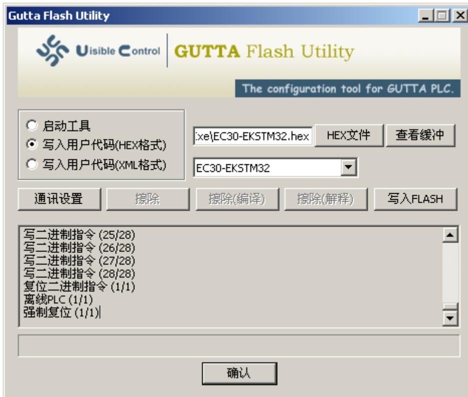
GUTTA Flash Utility 软件运行的界面如图所示，这里我们设置工作模式为“写入用户程序（HEX 格式）”。通过点击“HEX 文件”按钮，选择工程生成的 HEX 文件。然后在下拉框中选择 PLC 型号为 EC30-EKSTM32。点击“通讯设置”按钮配置实际和 EC30-EKSTM32 通讯的电脑端口。这些准备工作都完成后，便可点击“写入 FLASH”按钮，开始下载用户 C 语言程序。
