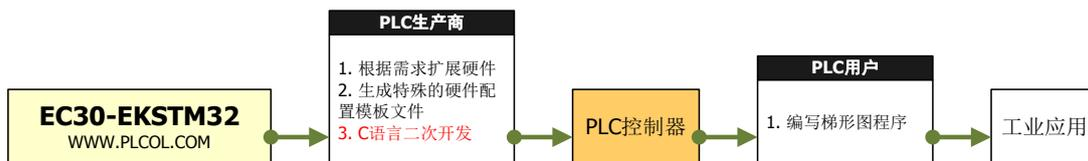
一些特殊的应用需要特殊的外围硬件，而 GUTTA Ladder Editor 软件中有限的几个驱动肯定不能涵盖所有需求。这个时候，就需要 PLC 生产商在 EC30-EKSTM32 核的基础上进行 C 语言二次开发，并将二次开发程序写入 CUSTOM 区随 PLC 硬件一起发布。
