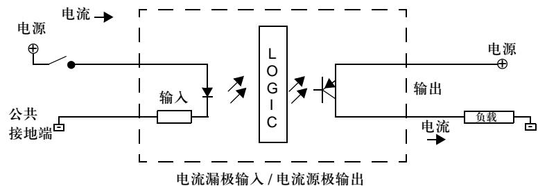
输入 COM 端子连到 +24V 电源端。输出 COM 端子连到 “-” 端或电源公共端。
