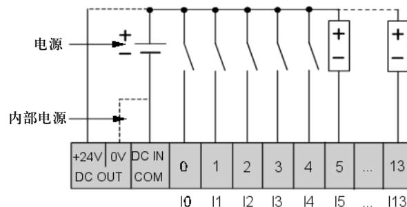
以下 DC 漏极输入接线图用于 TWDLCA•40DRF 系列控制器。
