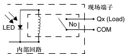
**晶体管源极输出触点**
