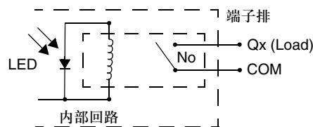
**晶体管源极输出触点**
