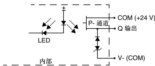
**晶体管漏极输出触点**
