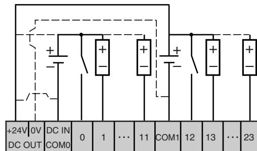
**AC 电源和继电器** 该图用于 TWDLC•A10DRF 系列控制器。
