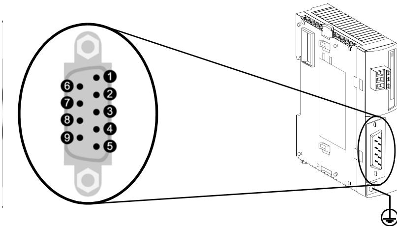
我们建议您使用符合标准 DIN 41652 的 9- 针阴性 D-SUB 连接器，或者参照有关国际标准把网络现场总线连接到主模块上。连接必须符合以下管脚分配：
