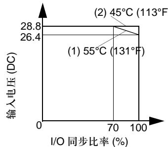
使用同样的控制器，在温度为 45°C (113°F)，所有的输入输出都同时接通且输入电压为 28.8 VDC 时比率如斜线 (2) 所示。
