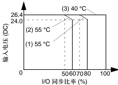
当使用 TWDLMDA40DUK 和 TWDLMDA40DTK 分别限制输入和输出时，能同时接通的比率按斜线 (2) 所示。
