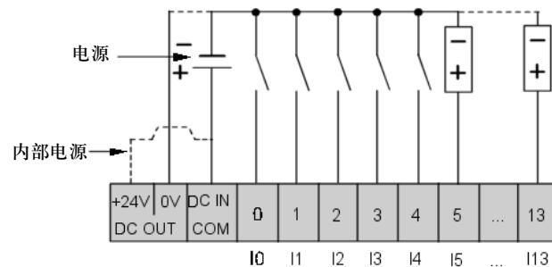
以下 DC 源极输入接线图用于 TWDLCA•40DRF 系列控制器。
