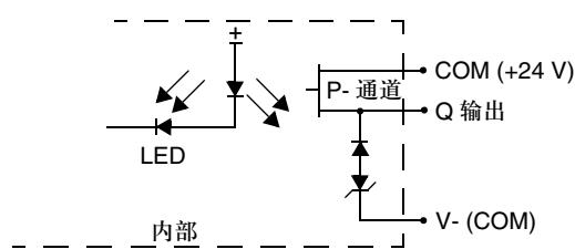
**晶体管漏极输出触点**
