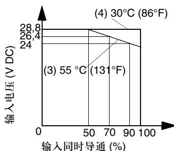
当使用 TWDDDI8DT，在 55°C (131°F) 输入电压 28.8 VDC，所有的输入可以同时接通。
