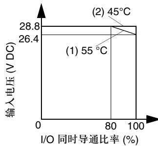
当使用 TWDDMM8DRT，所有输入输出可同时导通，在 55°C (131°F)，输入电压为 28.8 VDC。
