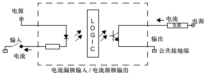
输入 COM 端子连到电源的 +24V 端。输出 COM 端子连到 “-” 端或电源公共端。
