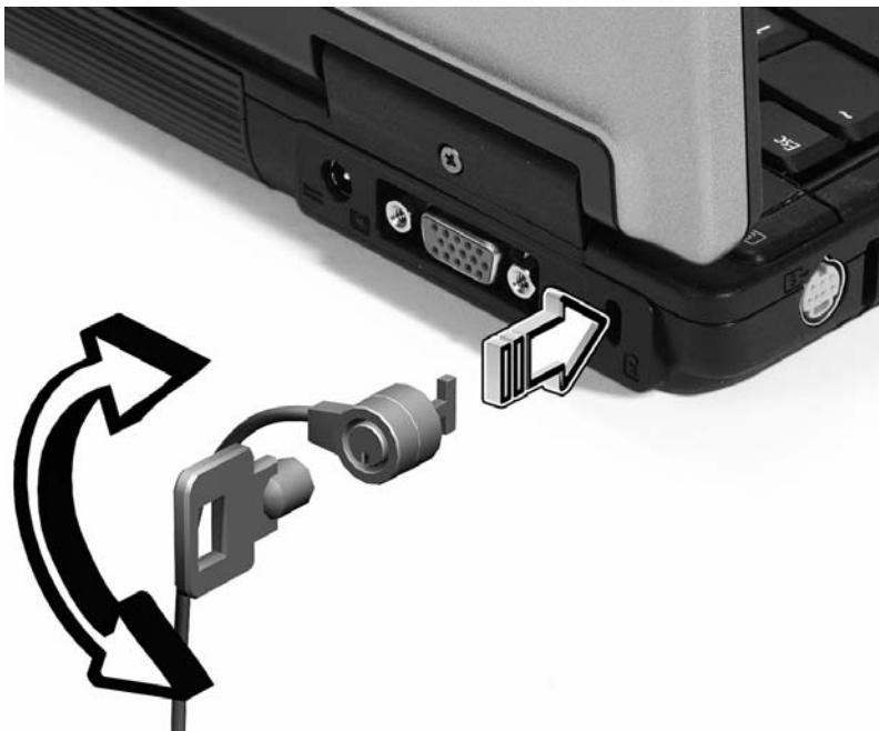
將電腦安全鎖電纜線繞著無法移動的物品打個圈，例如，桌子或鎖住的抽屜把手。再將鎖插入鎖孔中，並轉動鑰匙以便上鎖。另外一些沒有鑰匙鎖孔的機型，也可提供使用者來選擇。
