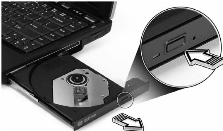
若在電腦電源關閉時，您可使用緊急退出孔來退出光碟機托盤。
