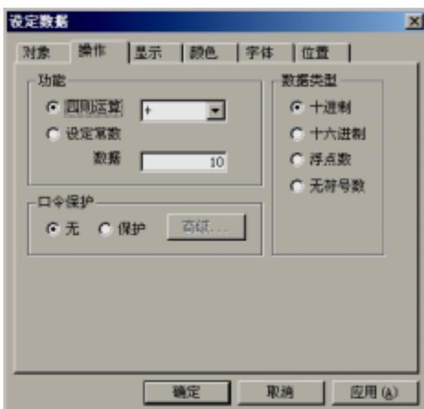
II 在操作选项中，如选择四则运算，则表示对设定的寄存器中的数据进行一次四则运算，如图中例子表示执行操作后对寄存器中的数据进行加 10 的操作。
