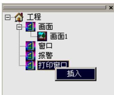
2 弹出新建打印窗口对话框，设置该打印窗口的名称，宽度，高度。并设置其触发对象，即 PLC 的
