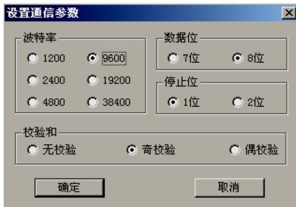
4 触摸屏和不同的 PLC 通讯，通讯参数设置不同，软件中的省缺值是选择 PLC 自动设定，如果没有特殊变化，不要任意改动，以免产生通讯错误。设置完成按“确定”，弹出新建工程。
