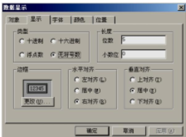
II 在“显示”中可以设置数据类型、长度、对齐方式以及文字的边框更改、颜色和位置。
