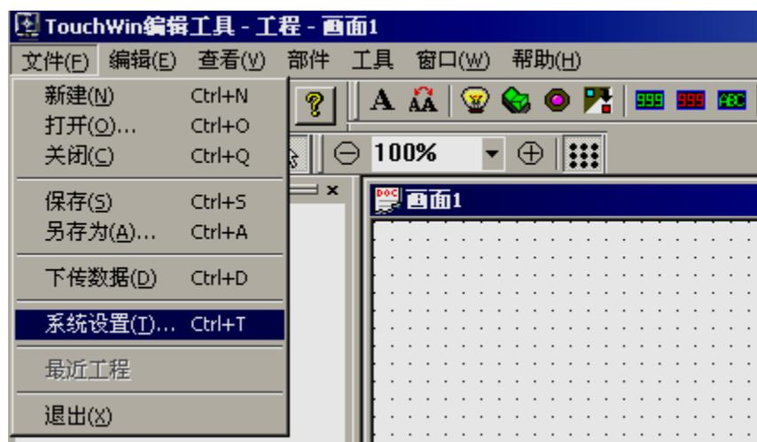
2 弹出系统设置对话框，在口令中输入密码，完成按确定键。
