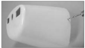
21. Drill 1/16" hole on the molded dot of the cowling. 在模點上鑽出週1.5mm的孔。
