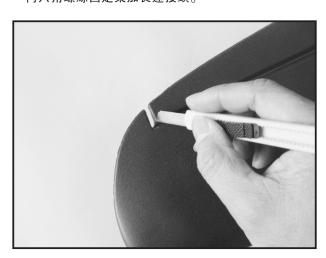
20. Carefully cut two ends of aileron. 小心切開副翼兩端。
