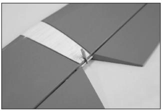
51. Trail fit the elevator on tail with torque rod installed. Do not glue at this step. When satisfied, remove the elevator and torque rod. 將升降舵控制桿以及升降舵、CA活頁試組裝到水平尾翼上。 在這一步驟不要粘合。配合確認沒問題後拆開。
