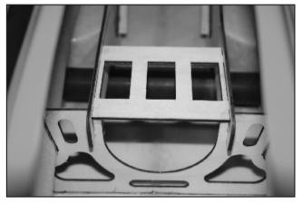
39. Glue the short guide tube in fuselage. 將主翼的固定樑管插入機身裡面,左右長度均等。
