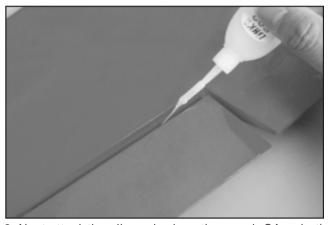
2. Next attach the aileron in place then apply CA on both sides. Make sure aileron is firmly glued. 安装副翼至主翼上使用瞬間膠水粘合紙活頁、使它產生 鉸鍊的作用。須確認粘合牢靠。
