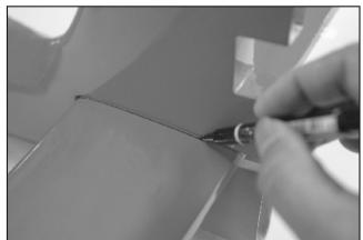
48. Trial fit horizontal tail in fuselage, center it then make marks on tail at four sides. 將水平尾翼裝在機身上,確認位置正確後使用油性筆沿 著機體四周做記號。
