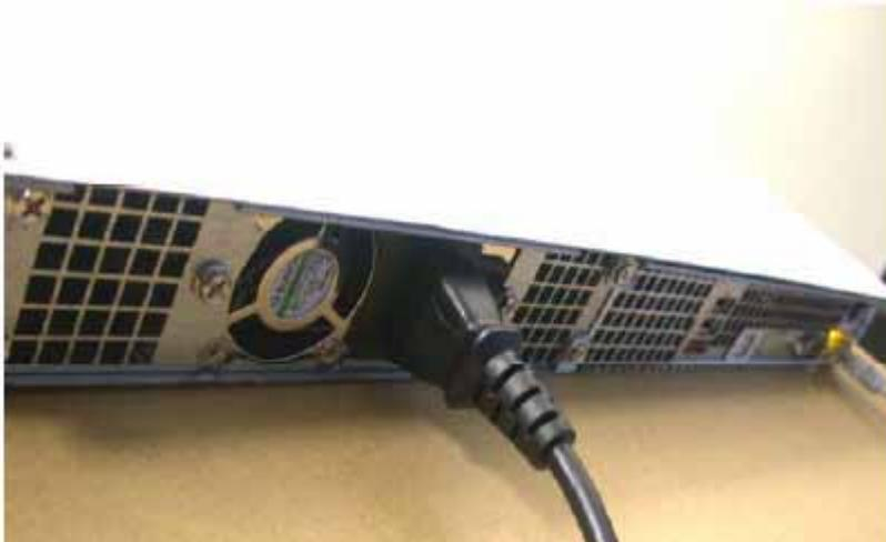
**注意：**如果您安装1U4500R，请务必连接两电缆。如果您不这样做，假如一电源发生了故障，系统将会报错并且警报将响起来。了解更多信息，请到第8章：故障检测。
