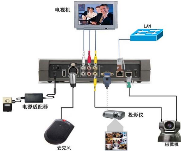
图2-1 最小安装连线图
