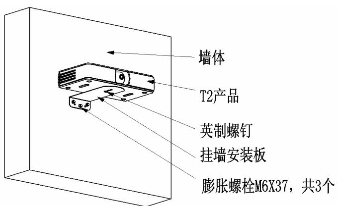
图B-1 挂墙安装
