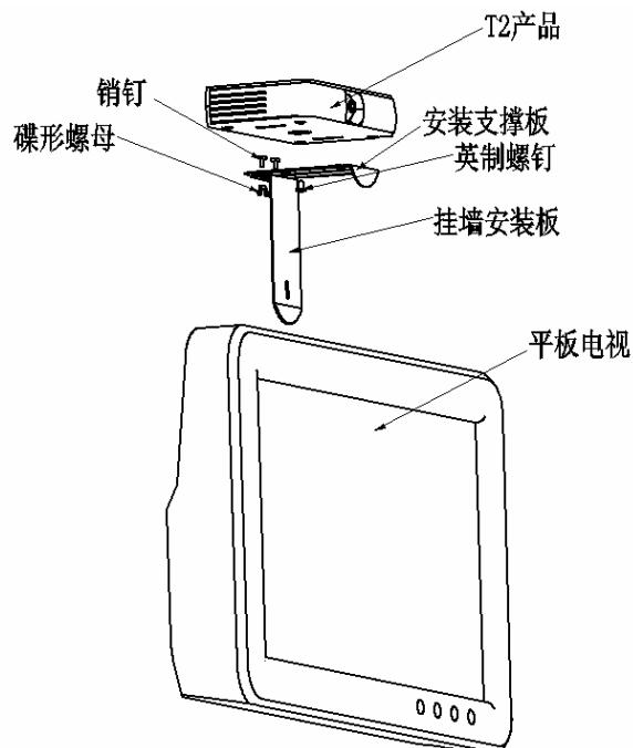
图B-4 终端安装
