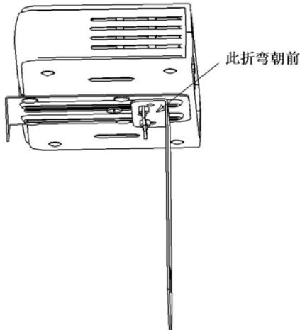
图B-5 终端安装
