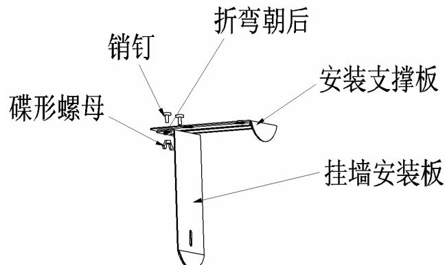
图B-3 挂墙安装板与安装支撑板的配合
