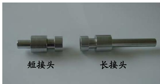
表接头用于夹表器与表和支座与表之间的联接，其中 DN15 与 DN20 口径有长接头和短接头之分。长接头应用于夹表器端，短接头用于支座端。
