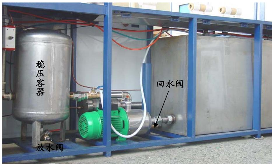
为消除水泵运转过程中引起的震动，水泵与水箱之间采用金属波纹管连接。稳压容器有二个作用，一是消除泵的脉动，二是排除水泵带入的气泡。在泵出口与稳压容器之间有一回水管，其目的为防止检表过程中产生水压过高和憋泵现象，请将回水阀门开启到一定位置（如开度的 1/3），使管道最大压力不超过 0.3MPa。
