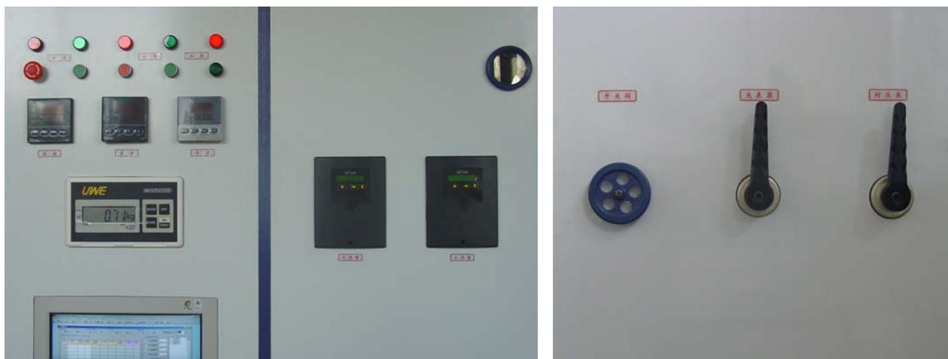
检定台的左侧控制与显示部分中，显示左面板安装有总电源、水泵和应急按键等启停开关；差压显示器（用于压损试验，单位 kPa。参数设定：放大倍数 1500，小数点 1 位。）；压力显示器（用于显示管道压力和耐压试验，单位 MPa）；水箱循环水温度控
