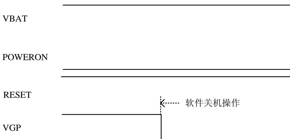
图 3-2 LC6311 关机流程
