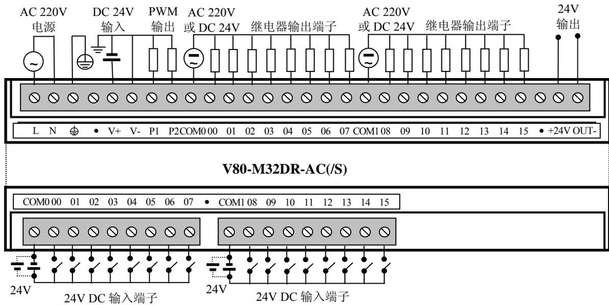
图 2.11 M32DR-AC(S)的 I/O 端子连接图
