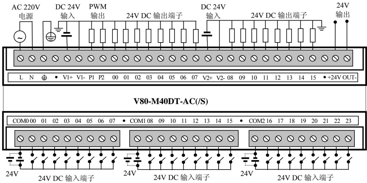
图 2.9 M40DT-AC(/S)的 I/O 端子连接图
