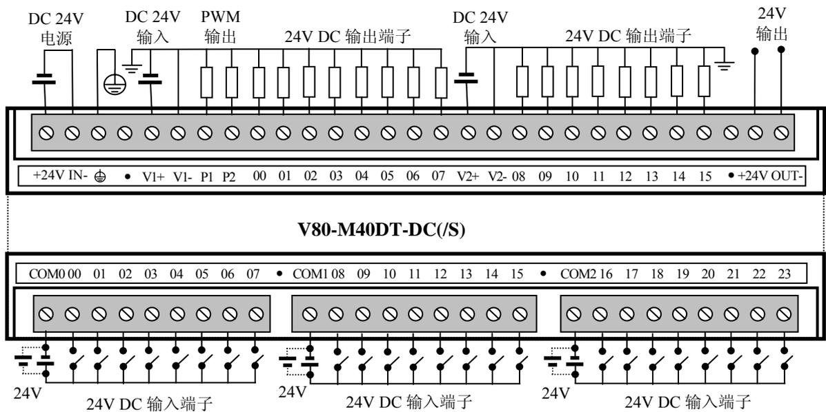
图 2.10 M40DT-DC(/S)的 I/O 端子连接图
