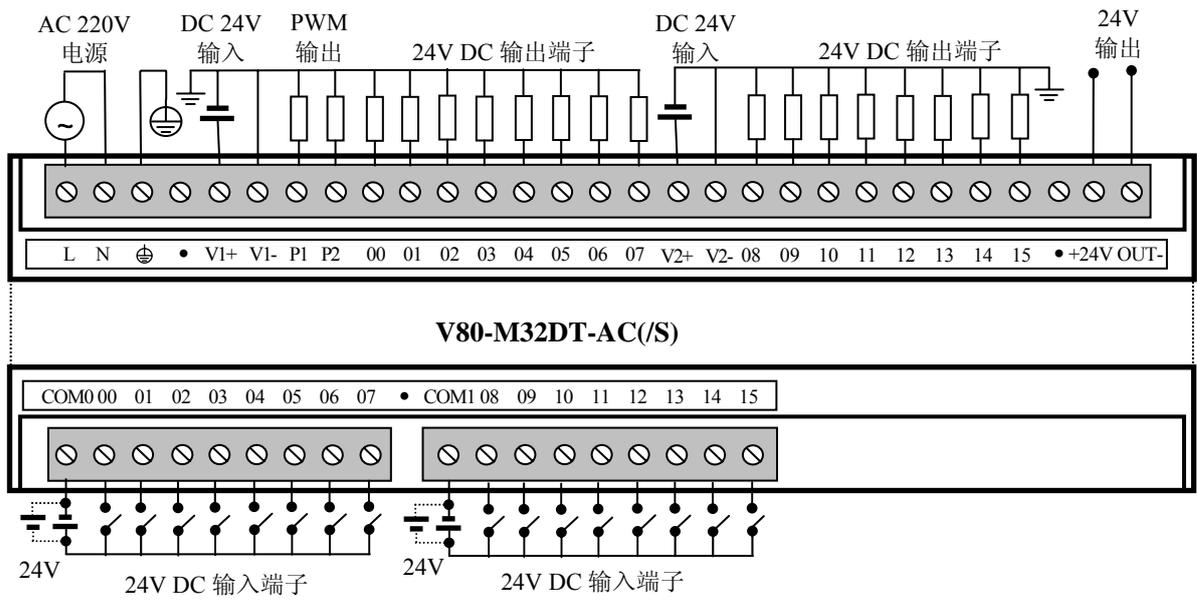
图 2.13 M32DT-AC(/S)的 I/O 端子连接图
