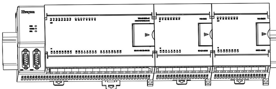
图 3.6 安装在导轨上的 CPU 和扩展模块
