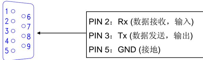
图 2.3 CPU 本体 COM1 接口引脚定义
