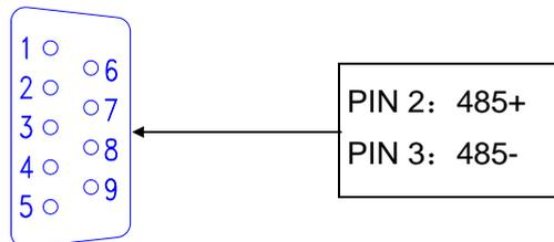
图 2.5 CPU 本体 COM2 接口引脚定义
