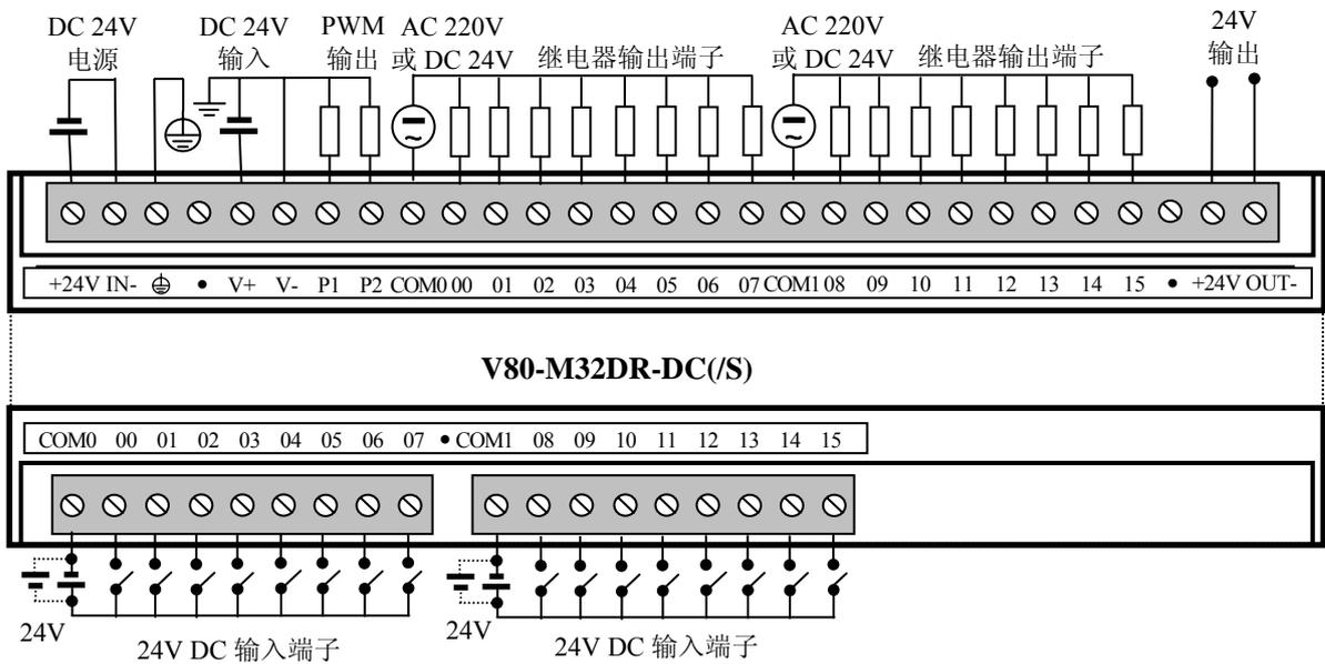
图 2.12 M32DR-DC(S)的 I/O 端子连接图
