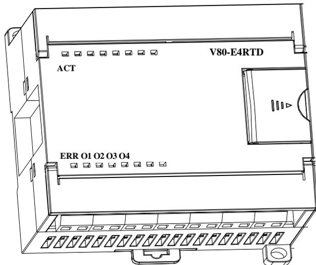
**执行:** 如果 E4RTD 正在进行通道数据工作或正与 CPU 进行通讯, 执行 LED 显示会以 5 Hz 的频率闪动.
