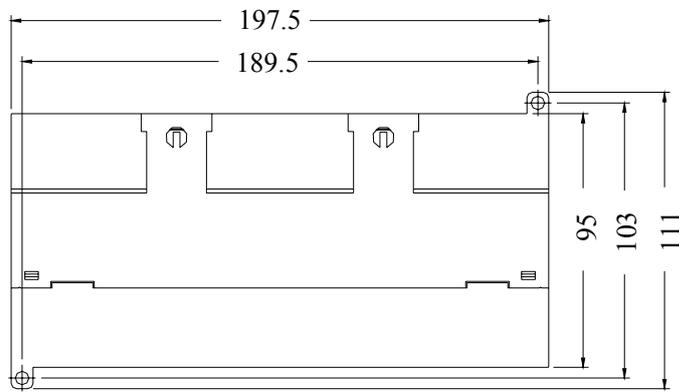
图 3.4 CPU 模块面板安装尺寸 (单位: mm)
