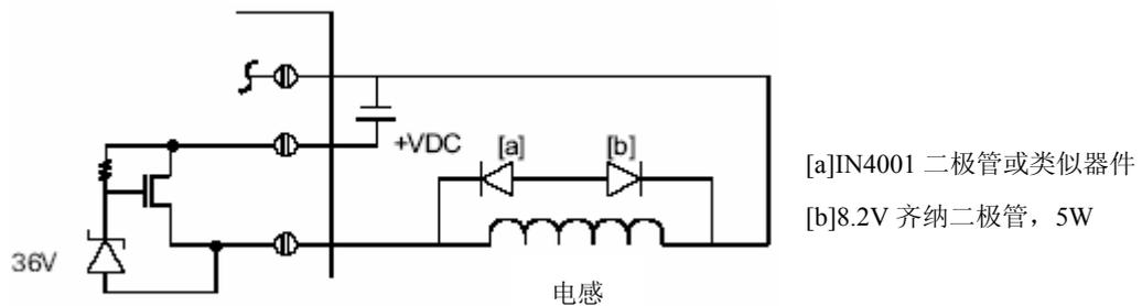
图 3.11 直流晶体管输出的齐纳二极管抑制
