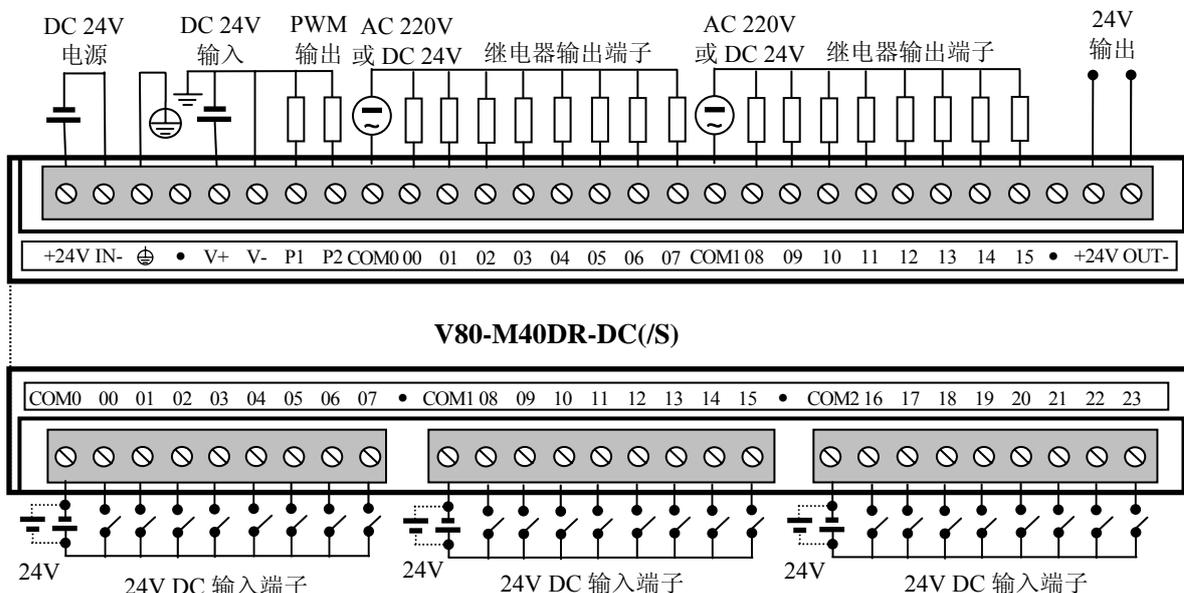
图 2.8 M40DR-DC(S)的 I/O 端子连接图
