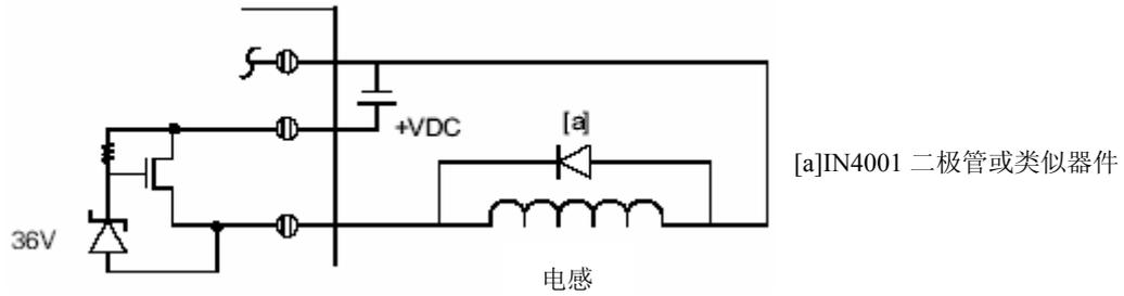
图 3.10 直流晶体管输出的普通二极管抑制
