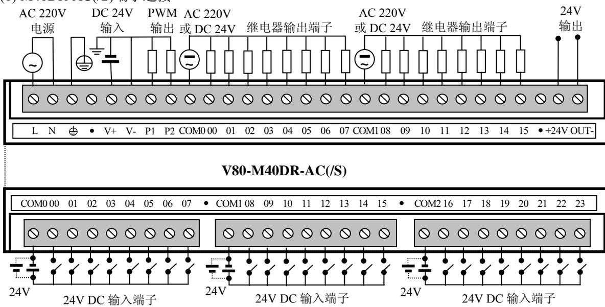
图 2.7 M40DR-AC(S)的 I/O 端子连接图
