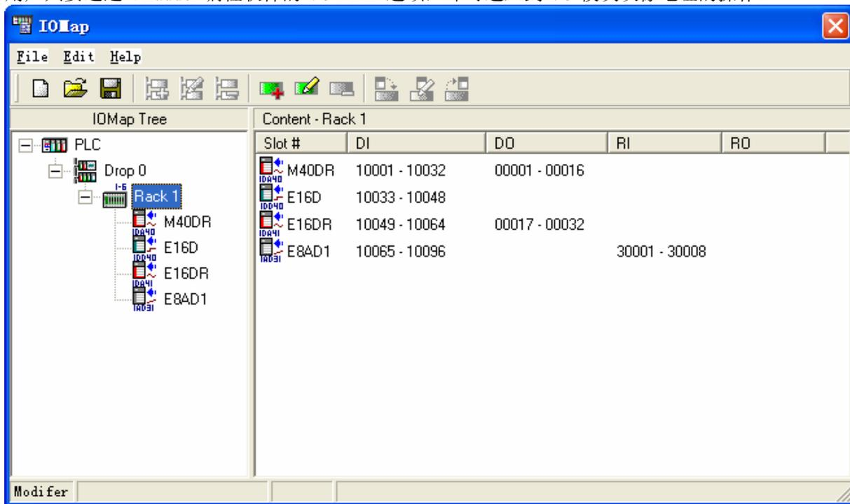
图 4.2 系统自动配置的 I/O 地址
