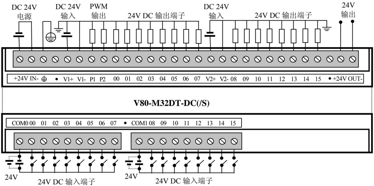
图 2.14 M32DT-DC(/S)的 I/O 端子连接图
