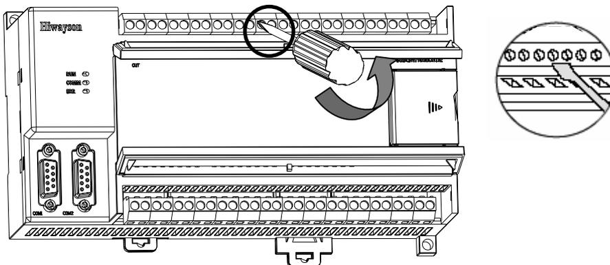
图 3.9 CPU 单元或扩展单元端子安装和拆卸连接线
