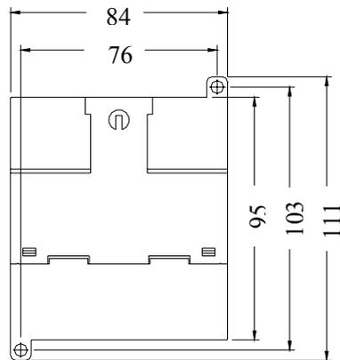
图 3.5 扩展模块面板安装尺寸 (单位: mm)
