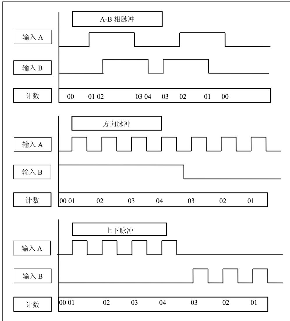
图 2.15 CPU 本体高速计数所支持的输入类型
