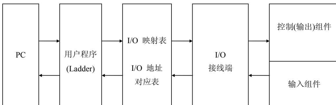
首先，由用户在个人计算机(或笔记本电脑)上，利用 VLadder 编程软件编辑梯形图程序，并将此程序加载到 V80 系列可编程控制器的内存。当程序在执行的时候，控制器读取输入组件的信号，并执行梯形图程序，再将结果送至输出组件。而实际上的 I/O 地址，由 I/O 地址对应表配合 I/O 单元位置，经系统(或用户)编辑而成。
