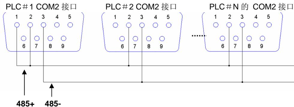
图 2.6 CPU 本体 COM2 的 RS-485 连接方式
