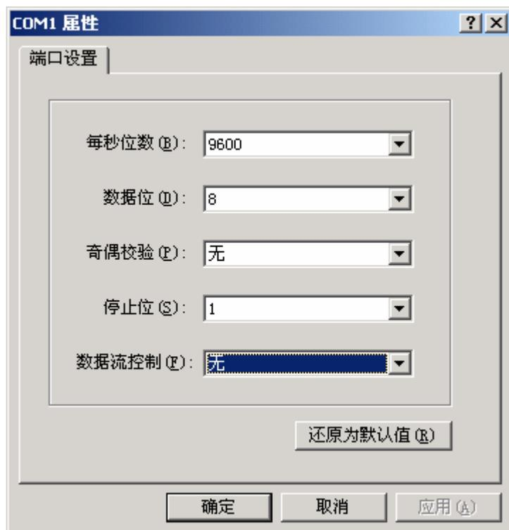
图4.4-5 端口属性配置设置
