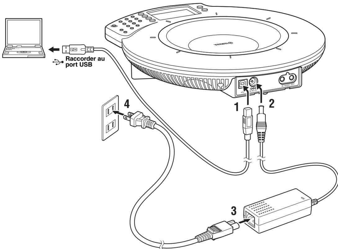
**1** Raccordez cet appareil au PC à l'aide du câble USB fourni.
