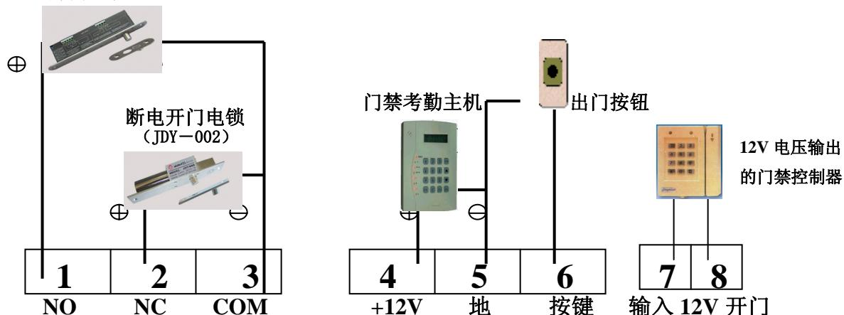
六、 1—3：NO 端与 COM 端，常态无输出，按键触发后输出 DC12V (0~10 秒)，
