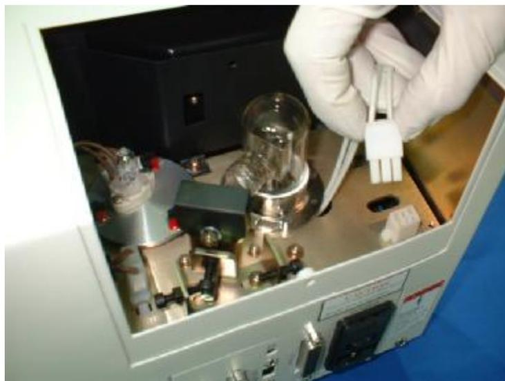
图 4-13 拔下氙灯引线插头
