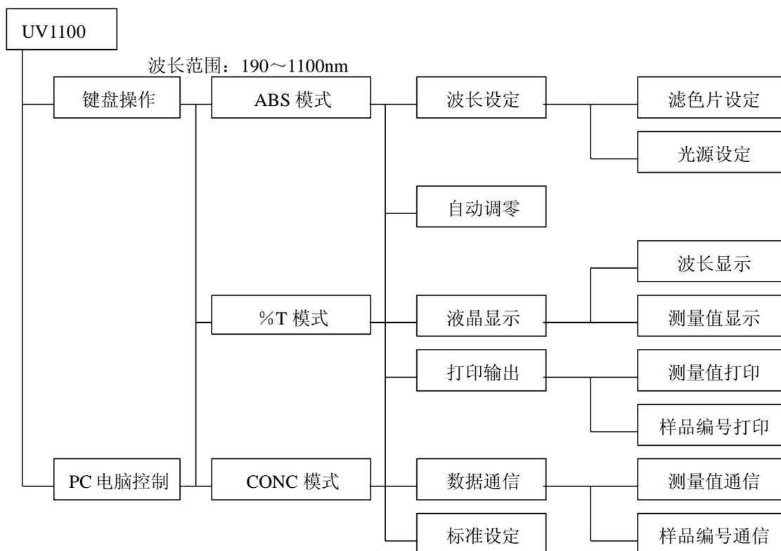
图 2-4 UV1100 分光光度计的功能模式示意图
