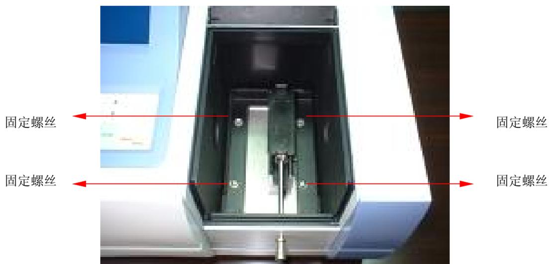
图 4-2 拆下比色皿架部件的固定螺丝
