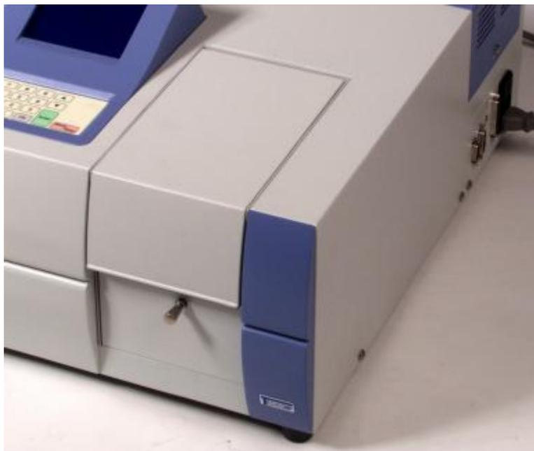
图 2-7 UV1100 分光光度计的样品室示意图
