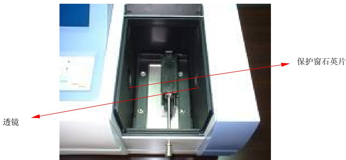
图 4-6 样品室内保护窗石英片与透镜的位置
