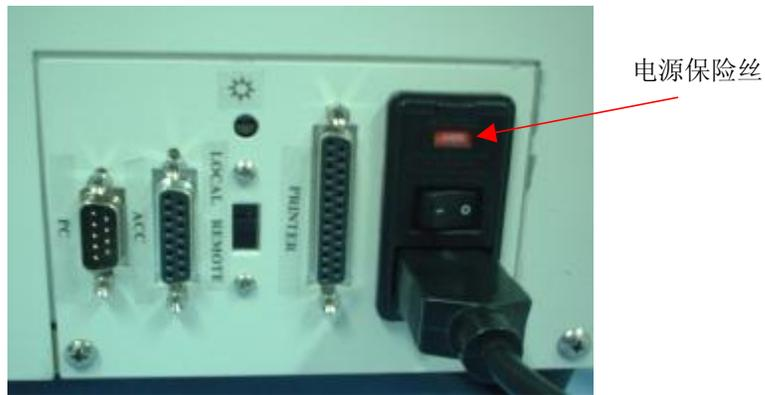
图 1-3 UV1100 分光光度计电源部分
