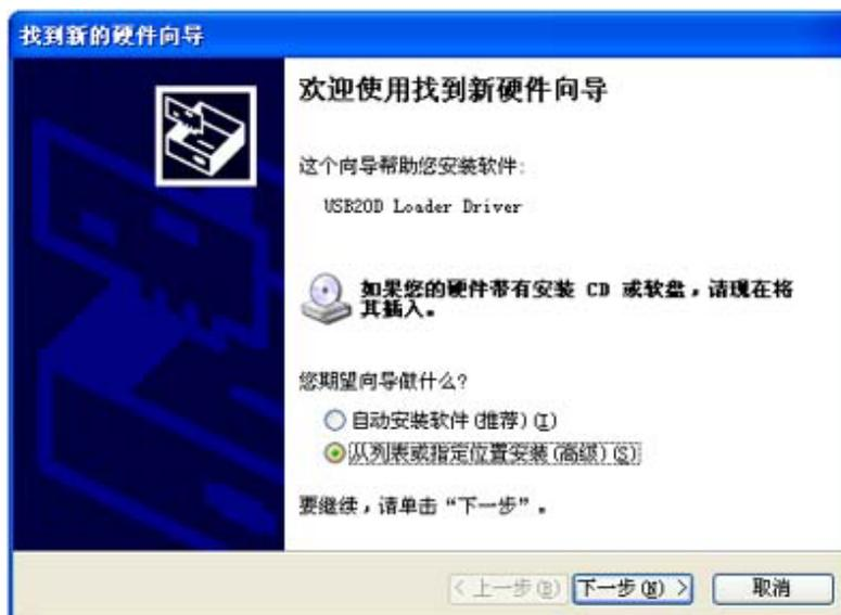
将 USB 四芯电缆扁平的一端插入计算机后面的任意一个 USB 端口 ,将另一端插入 USB20D 的 USB\_T 插座上 ,硬件连接即完成。此时电脑提示发现新的 USB 设备 ,弹出上图界面 :
