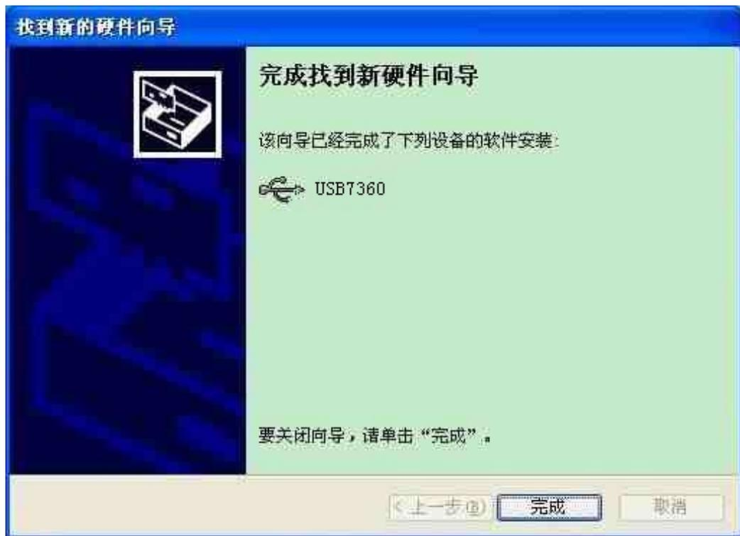
检查 USB-7360 板卡驱动是否已经正常安装，可以到“设备管理器”里查看一下是否有“USB7000 系列数据采集卡”点开后面会有“USB7360”就证明其驱动已经正确安装。
